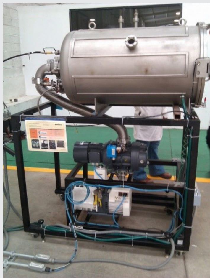
Figura 1. Reactor para nitruración iónica.
