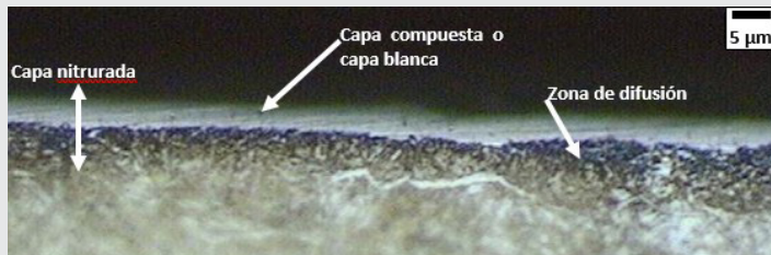
Figura 3. Producto formado en el acero 4140 nitrurado por plasma durante 1 hr.
